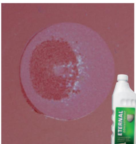
Použijeme-li na očištění ETERNAL odmašťovač, nelze barvu od povrchu odtrhnout ani při extrémních silách. Barva se díky dokonalé přilnavosti nikdy neoloupe. V části plochy je přídržnost barvy dokonce vyšší než přilnavost lepidla.
